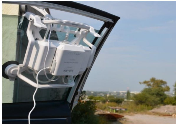
Imagen 8. Sniffer montado en vehículo
